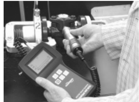
Prüfung eines Ableiters
